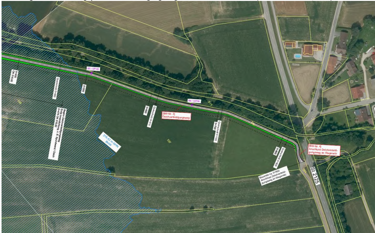
Abbildung 3: Ausschnitt Lageplan Deichverteidigungsweg Bau-km 0+475 bis 0+850 (Stand 08.05.2025, o.M.)
